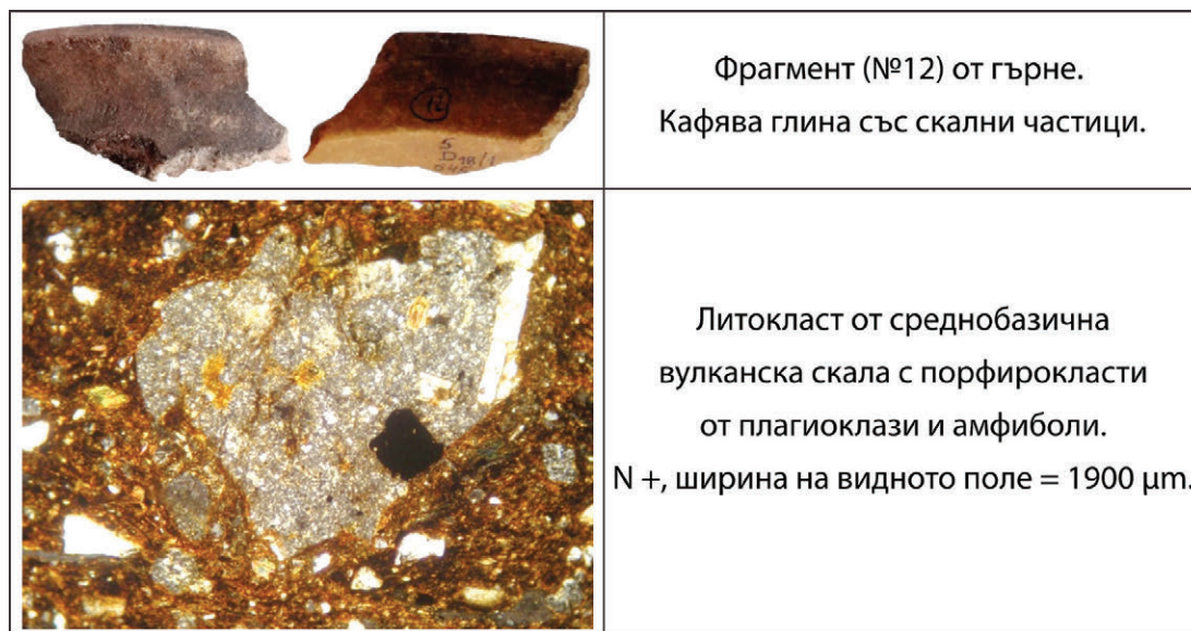
Обр. 14. Петрографски анализ на средновековна керамика от обект № 5. Макроснимка на фрагмента и микроснимка на дюншлифа
